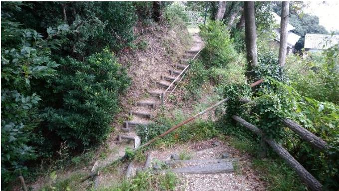
⑳尾根上を進攻してくる来る敵軍に対し、尾根をv字に切り開いて通行を不可能にする防御施設。平時は丸太など簡易な板で通行し、戦闘時には板を落として遮断する。少し危ないです。
